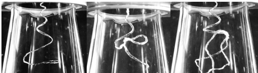
Рис. 10. Визуализация кавитирующего вихревого жгута при Q = 80 \text{ м}^3/\text{ч} , N = 500 \text{ об/мин} (1) – невозмущенная спираль, (2) – изолированное вихревое кольцо, (3) – “надетое” вихревое кольцо.
